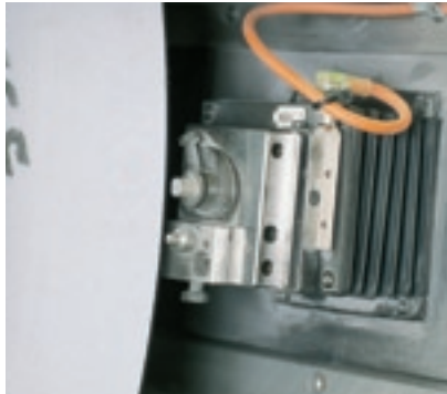
Diamantbelegte Abrichteinheit zum Vor- und Feinabrichten
