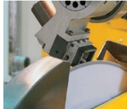
Abrichteinheit für Schleifscheibenrückseite
