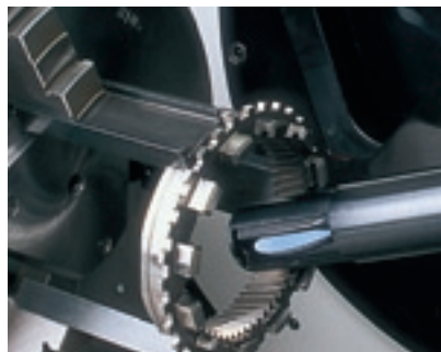
Schleifkopf für Innenverzahnungen beim Schleifen einer Schrägverzahnung
