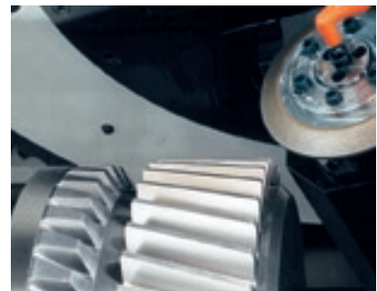
Schleifen grossmoduliger Verzahnungen mit galvanisch belegter CBN Schleifscheibe
